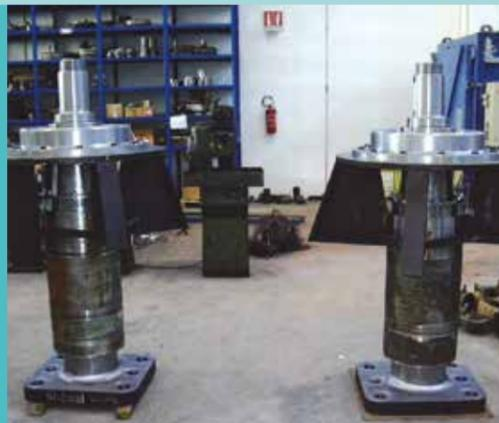
I Piedi poppieri “Miotto” sono in grado di fornire le **migliori prestazioni, a parità di potenza installata**, reperibili sul mercato. Da applicazioni da 20 a 300 Kw con motorizzazione elettrica o idraulica. Sono fornibili con elica libera o elica intubata. Possono, in funzionamento, traslare verticalmente oltre che a consentire virate, grazie alla loro rotazione con angoli di barra fino a 40°.
