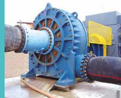
Esegue la **revisione** totale su pompe ad asse nudo o a immersione di qualsiasi tipo e potenza, effettuando lo smontaggio eseguendo tutti i controlli dimensionali. Effettua la **costruzione** dei componenti usurati come da disegno costruttivo, la **sabbiatura** e **verniciatura** interna dei vari componenti con prodotti adeguati ai vari liquidi di pompaggio.
