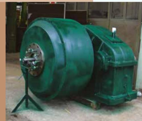
I giunti idraulici **Miotto** sono forniti con cassa in lega leggera e con cassa in ghisa sferoidali, coprono un campo di potenze dai 0.5 ai 1200 KW.
