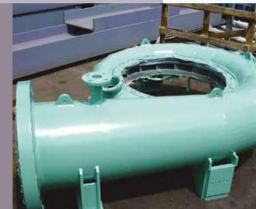
La **Miotto** srl realizza **turbine idrauliche a reazione** che sfruttano piccoli dislivelli, fino a qualche decina di metri, ma con grandi portate, da 200/300 m<sup>3</sup>/s in su. Costruttivamente è un'elica, dove le pale si possono orientare, al variare della portata d'acqua permettendo di mantenere alto il rendimento fino a portate del 20-30% della portata nominale.
