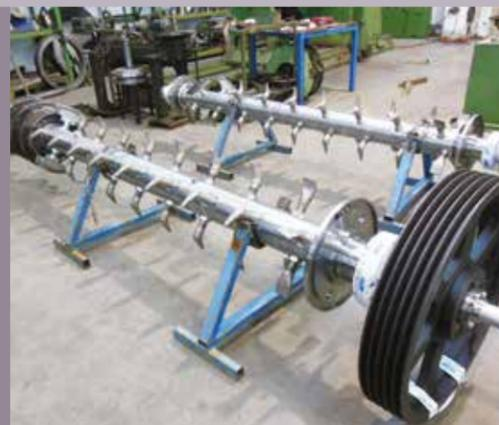
Siamo in grado di fornire equilibrature statiche e dinamiche elettroniche certificate secondo ISO 1940 di rotor
